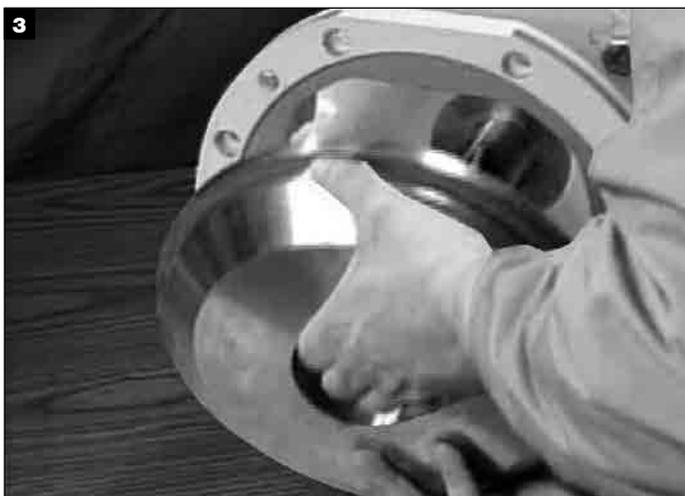
Déposez le boîtier de la garniture mécanique de l'équipement.
