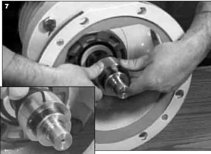
Appliquez une fine couche de graisse sur le joint torique de l'arbre et faites glisser l'unité tournante sur l'arbre de sorte que l'arrière de l'unité soit aligné sur le repère. Serrez toutes les vis de montage de manière homogène.
